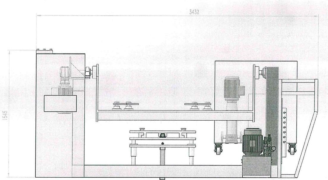
为了在底下增加拔销的工装，使得机器整体高度提高，对于修理底部不方便，可以考虑将拔销的工装单独做成一台设备。
