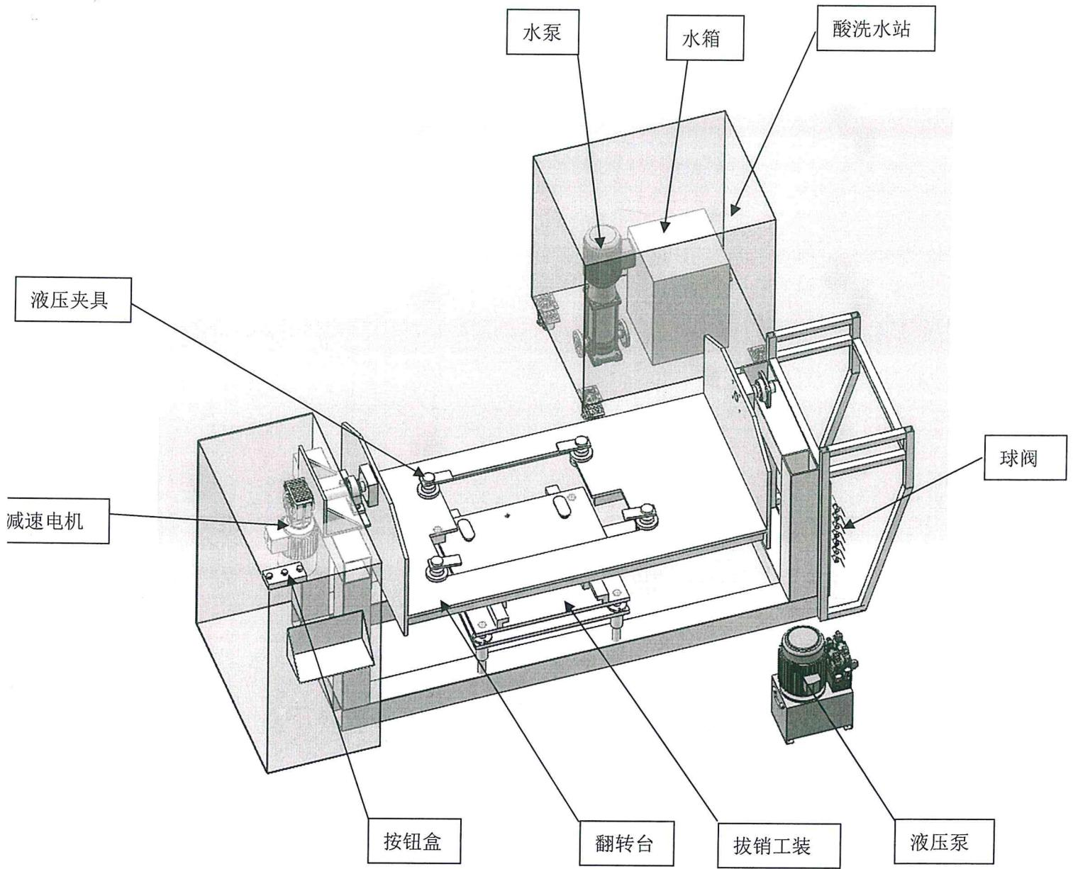
工作流程：将模具放在翻转台上，按夹紧按钮，液压自动将模具夹紧，按下翻转按钮，电机带动翻转台旋转 180 度，方便从底部维修模具。
